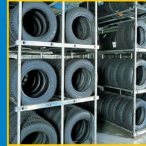
Reifen altern aufgrund physikalischer und chemischer Prozesse, wie UV-Strahlung, Feuchtigkeit, Hitze, Kälte usw. Das gilt auch für nicht oder wenig benutzte Reifen. Um diesen Prozessen entgegenzuwirken, werden Gummimischungen Substanzen beigemischt, die leistungs-
